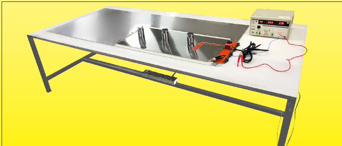
Messgeräte für den Gesamtleckstrom im kalten Zustand
