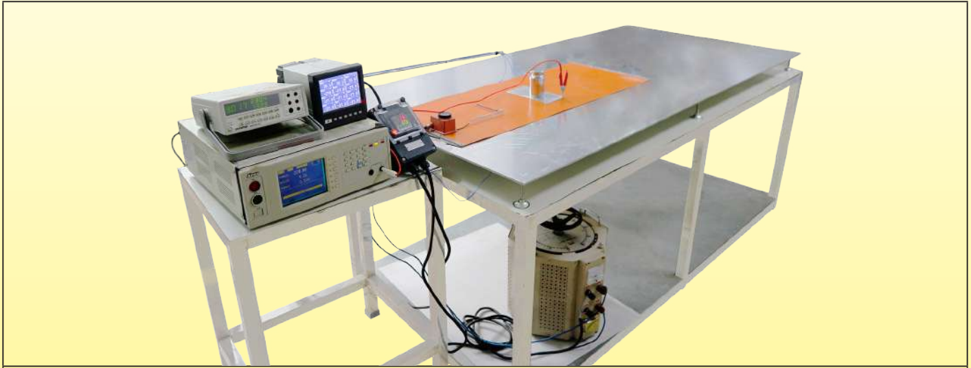
Messgeräte für den Gesamtleckstrom im heißen Zustand
